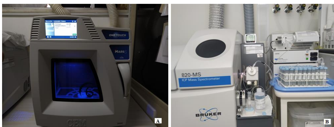
Fig. 9. A. Digestão em microondas; B. Análise das amostras de sedimento em espectrômetro de massas com plasma acoplado por indução.
