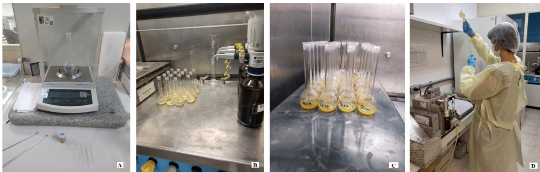
Fig. 5. A. Pesagem de sedimentos em balança de precisão; B. Acidificação das amostras de sedimento; C. Aquecimento das amostras de sedimento em chapa elétrica; D. Análise das amostras no espectrômetro de absorção atômica e vapor a frio (Foto: Thais Queiroz).
