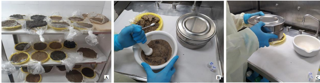
Fig. 4. A. Secagem de sedimentos a temperatura ambiente; B. Preparação do sedimento; C. Peneiragem do sedimento.
