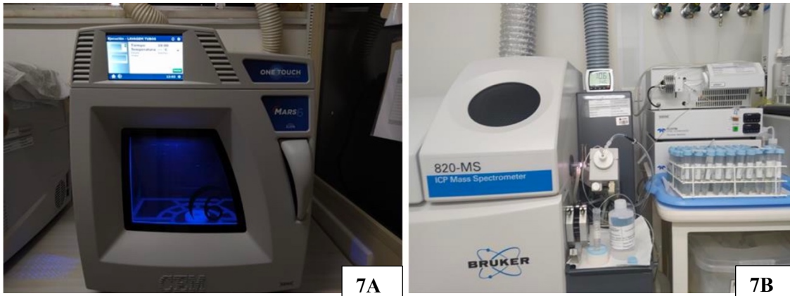
Fig. 7.A. Digestão ácida realizada em microondas; B. Espectrômetro de Massas com Plasma Acoplado por indução (Foto: Thais Nascimento).
