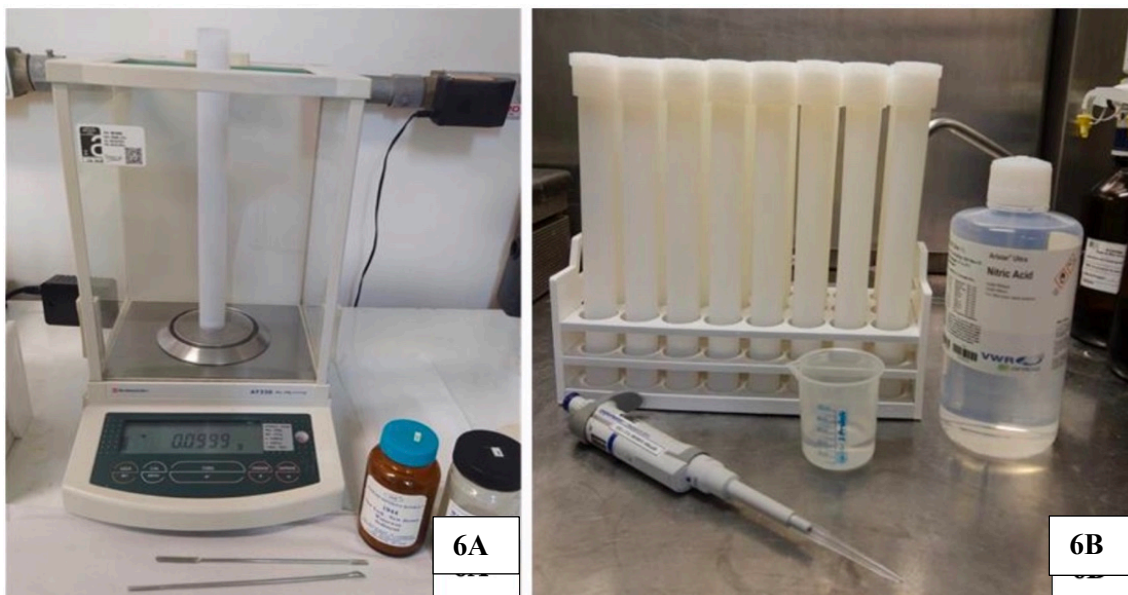
Fig. 6.A. Pesagem das amostras de sedimento em balança de precisão calibrada; B. Acidificação das amostras de sedimento (Foto: Thais Queiroz).
